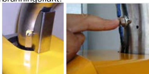
Skyddskåpa överhettningsskydd, samt återställningsknapp.
